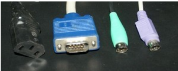
Prises : d'alimentation, vidéo type VGA, de souris et de clavier
