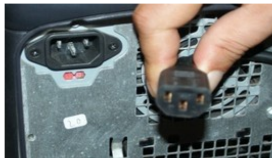
Prises mâle et femelle du bloc d'alimentation
